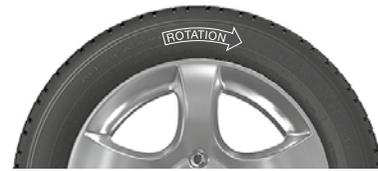
Beispiel einer Kennzeichnung der Laufrichtung
